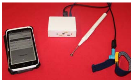
Fig.9 Electrogustomètre : un générateur de courant constant La stimulation consiste à appliquer les cations de la salive (H + , Na + ) du sujet sur ses propres récepteurs gustatifs à l'aide de très faibles courants.
